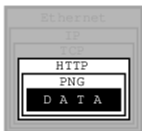
Рисунок 2. Уровни протоколов, покрываемые сокетами
